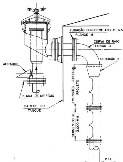
Figura 52 – Sistema semi-fixo
