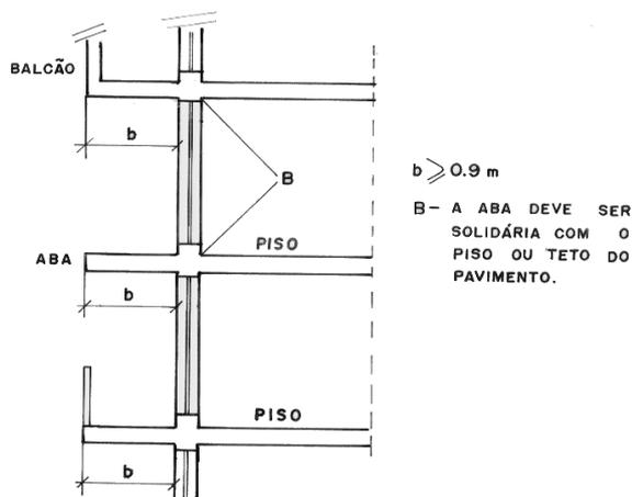
Figura 21 - Isolamento vertical de aberturas em laje
